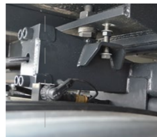
Système de pesage embarqué Peser précisément les structures avec les cellules de charge Digi Sens
