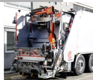
Système de pesage sur lève-conteneur Eleiro: rapidité élevée pour chaque type de déversement
