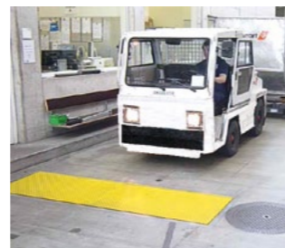
Système de pesage de traversée Dernier contrôle de poids avant le rangement du conteneur dans l'avion
