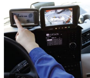
Eleiro Touch Réglage du système, données de pesage, tout se trouve à disposition sur l'écran tactile
