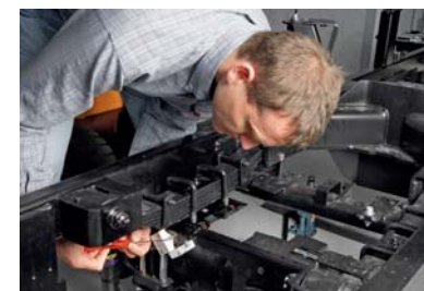
Sensormontage an einem LKW-Chassis für Versuche.
